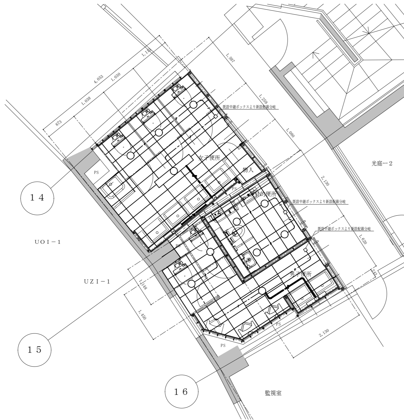
便所照明器具更新設置配線図 S=1/30
